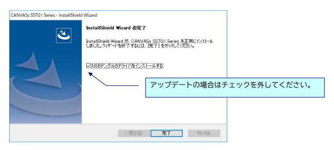
「USB ドングルのドライバをインストールする」のチェックを外し、[完了]をクリックしてインストールを終了してください。
