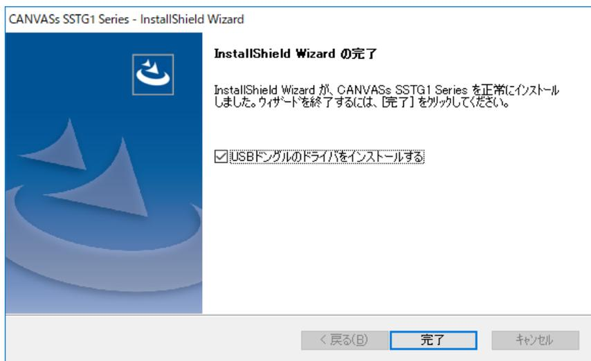
「USB ドングルのドライバをインストールする」の**チェックを外し**、[完了]をクリックしてインストールを終了してください。
